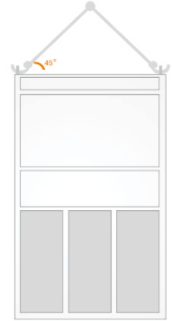
Vinç ile kaldırma ve taşıma
